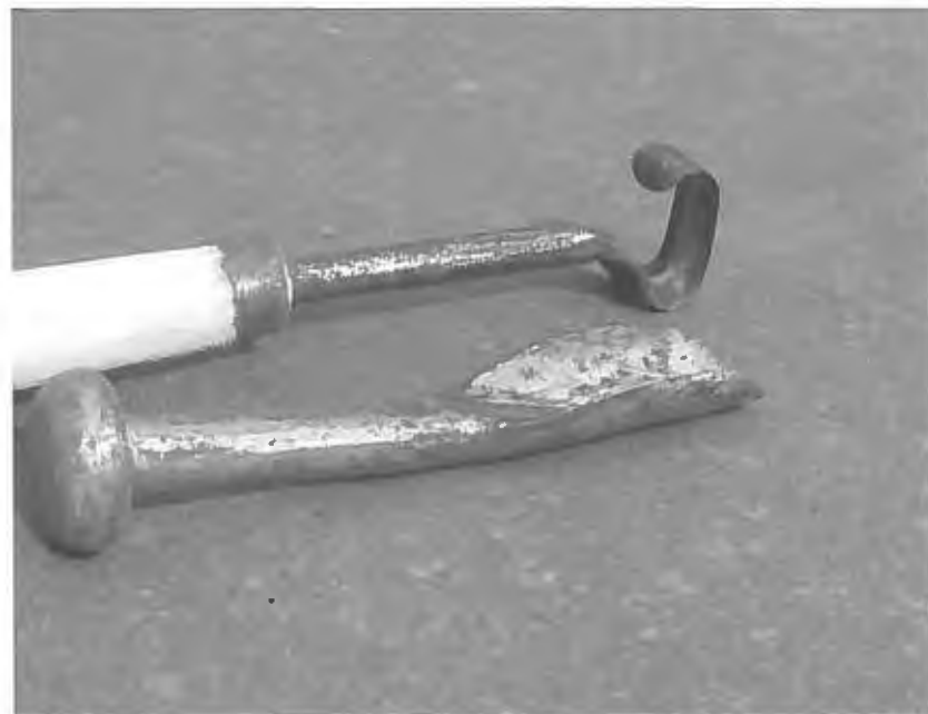
Twee gereedschappen van Vic Boeren: de guts (uitgeholde bijtel) en het hielmess
