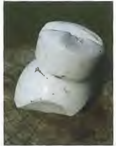
Fragment van de grootste isolator.
