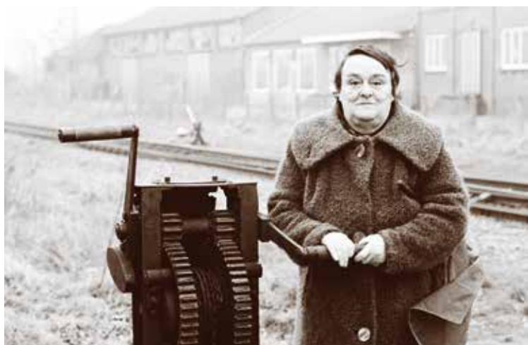
In weer en wind.... zij was altijd paraat. Vanuit de overgang aan de Chaamseweg werden, op afstand met een kabel-techniek, de slagbomen aan de Pastoor De Katerstraat gesloten en geopend.
