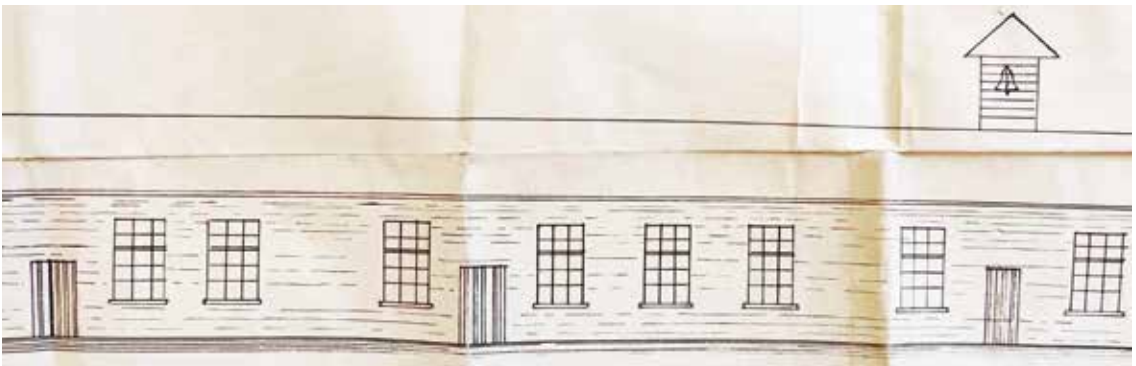
Bouwtekening van de noodkerk. De zijgevel is vier meter hoog. BHIC Den Bosch, 156 nr. 90
