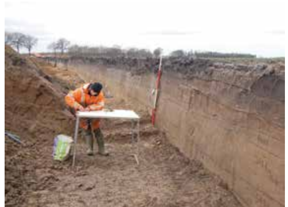
De fysisch geografe komt regelmatig langs om de bodemopbouw te bekijken. Het profiel wordt gefotografeerd en getekend.
